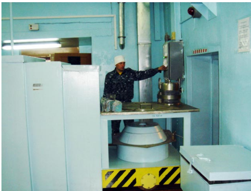
Рисунок 2.2.3.6 – Блок биологической защиты Комплекса по перегрузке ИИИ (Толщина стен по бетону 120 см)
