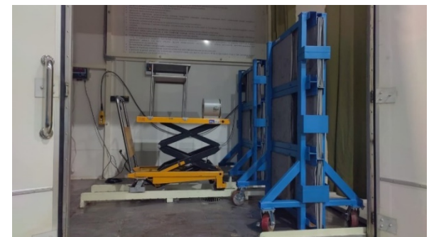
Передвижной стол-штатив для спектрометра и защитные свинцовые экраны
