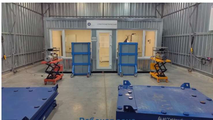
Рабочая зона (Поворотные платформы, спектрометры, защитные свинцовые экраны)
