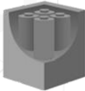
Бетонный контейнер, содержащий канистры/бочки с САО
